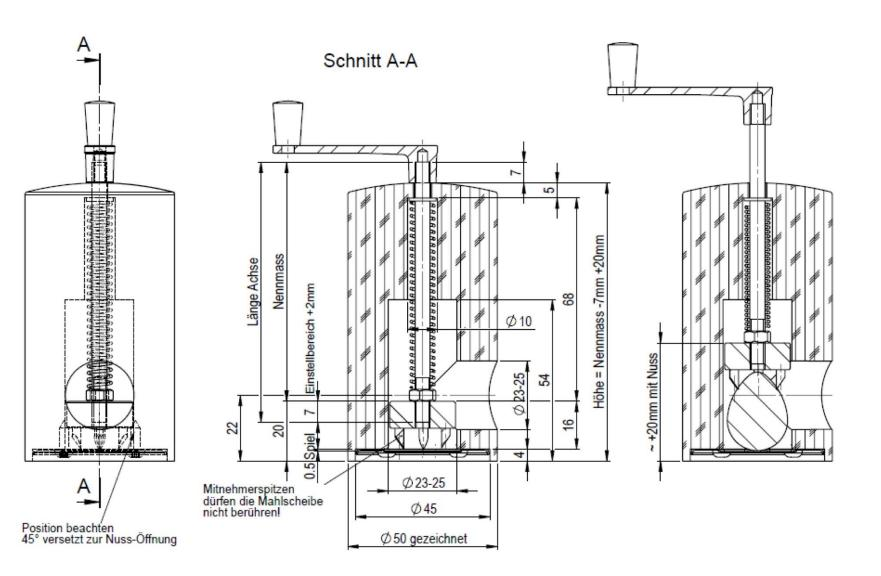
Die Muskatnuss wird über die Querbohrung ø23-25mm zugeführt. Beim Anschrauben der Mahlscheibe ist darauf zu achten, dass die Spanplattenschrauben 45° versetzt zur Querbohrung montiert werden. Bei dieser Ausführung bietet sich die Dimension ø3x10mm an. Die kürzeste Höhe vom Gehäuse ist ca. 93mm (Länge Achse von 87mm).
