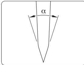
Eine Forstaxt braucht einen Schneidenwinkel ( $\alpha$ ) von 30–40°. Die Schleiffasen abrunden, damit die Axt leichter arbeitet.
