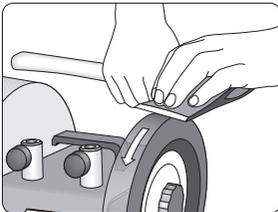
Durch Abziehen und Polieren auf der Lederabziehscheibe wird die Schneide schärfer und mehr dauerhaft. Immer weg von der Schneide abziehen.
