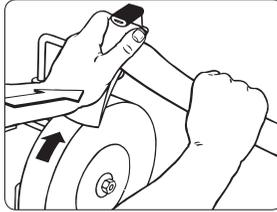
Drücken Sie mit Ihrer Handfläche nahe beim Stein auf die Axt. Die Axt wird automatisch gegen den Anschlag der Vorrichtung gepresst – und somit ist das Schleifen am wirkungsvollsten.
