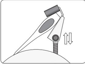
Die Axt in die Vorrichtung setzen. Den Schneidenwinkel durch Verstellung der Universalstütze einstellen. Entweder nach dem befindlichen Winkel oder nach einem neuen Winkel mit Hilfe der Winkellehre.
