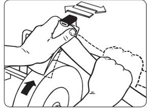
Folgen Sie der Form der Schneide, indem Sie den Stiel heben oder senken. Lassen Sie die Vorrichtung auf der Universalstütze hin und her gleiten, damit der Stein gleichmäßig abgenutzt wird.
