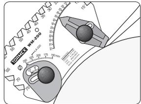
Der Schneidenwinkel kann mit der Winkellehre WM-200 eingestellt werden.
