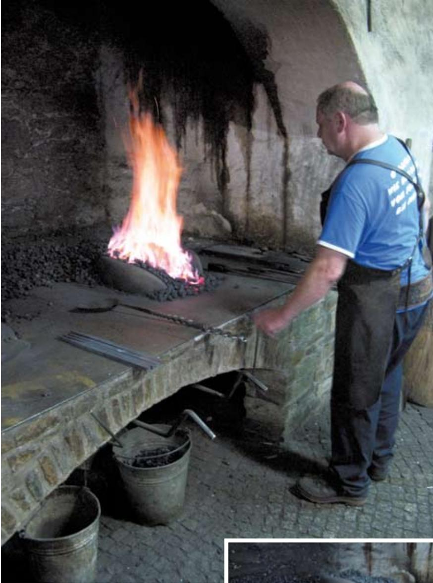
Der Vorgang ist aufwendig und erfordert viel Geschick und Erfahrung. Den richtigen Zeitpunkt zum Schmieden erkennt Herbert Gläser alleine an der Farbe des glühenden Eisens, dann wird im Wechsel an unterschiedlichen Federhämmern geschmiedet. Dieser Vorgang wird mehrmals wiederholt.
