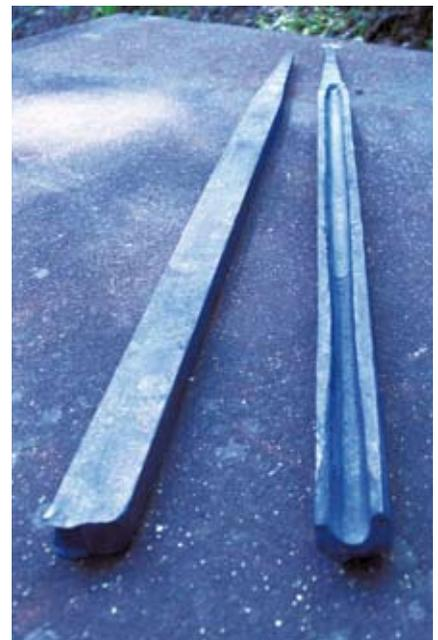
Die Drechselwerkzeuge von Herbert Gläser sind in handwerklicher Tradition hergestellt. Profis und mittlerweile auch viele Amateure schätzen die besonders hohe Qualität und Schneidenstandzeit. Jedes Werkzeug wird mit großem Aufwand als Unikat gefertigt und die komplett durchgehend gehärtete Nutzlänge garantieren eine lange Lebensdauer. Werkspuren verleihen den Drechselstählen einen besonderen, einzigartigen Charakter. Gläser-Werkzeuge sind über das Drechselzentrum Erzgebirge erhältlich.
