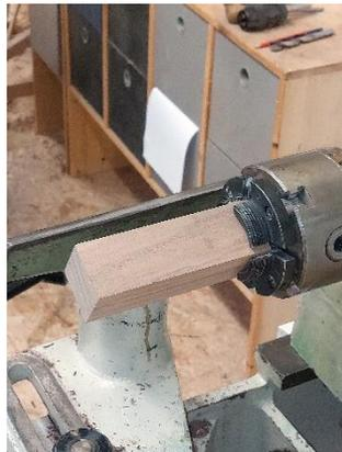
Nach dem winkligen Abstechen wird passen gebohrt und ein kleiner Zapfen für die Zwinde angedreht.
