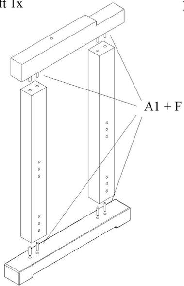
!!! TIPP !!! Nicht Bohrungen mit Leim füllen, sondern aufstreichen des Leims auf die Dübel.
