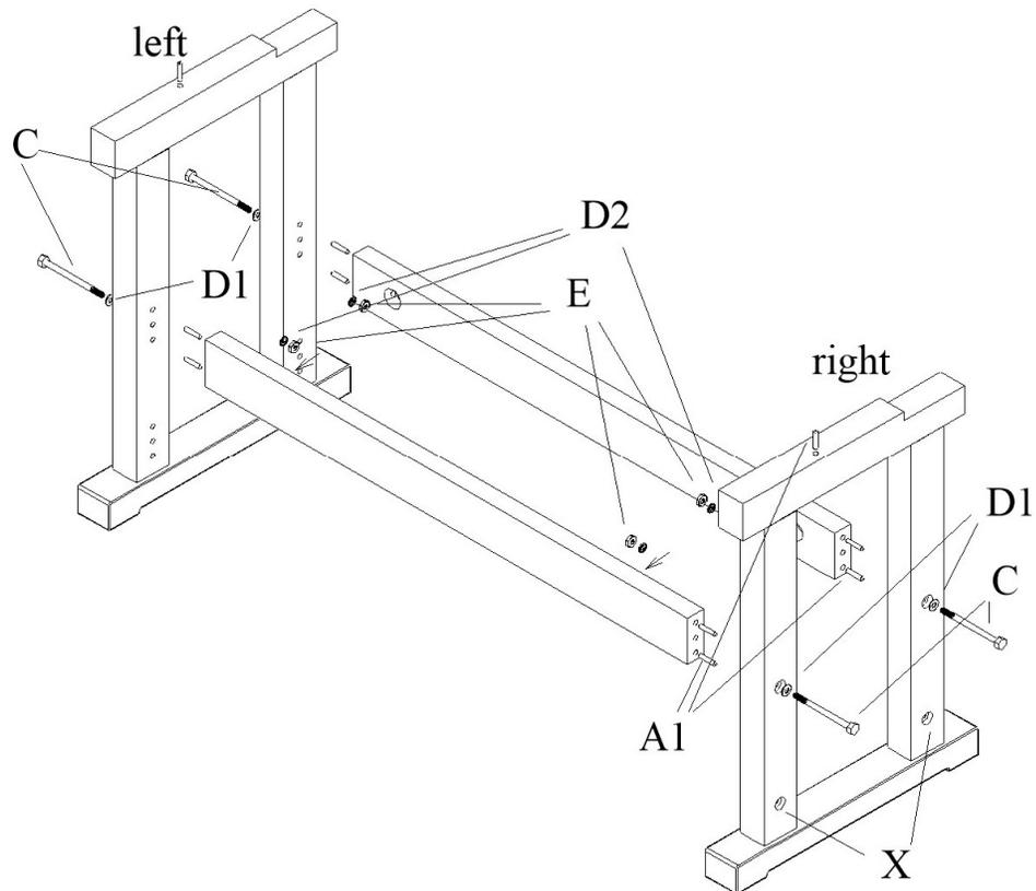
X = Bohrungen für die Querbalken, wenn ein Untergestell verwendet wird!
