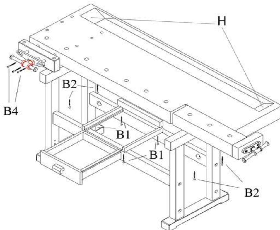
Wichtig! Holzkeile werden separat (Pos. H) geliefert. Der Hersteller empfiehlt, die Holzkeile nach 3 - 4 Wochen hinzufügen. Die Holzbank muss auf die Umgebung angepasst werden. Bei Bedarf passen Sie die Größe von Keilen nach der Größe des Werkzeugs an.
