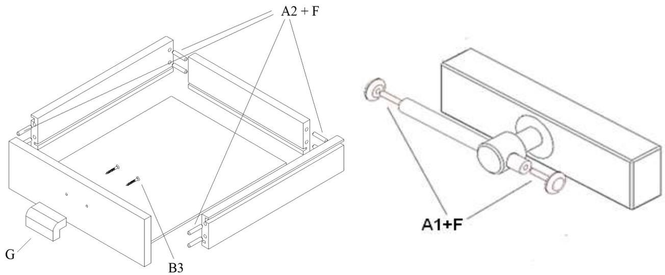
!!! TIPP !!! Nicht Bohrungen mit Leim füllen, sondern aufstreichen des Leims auf die Dübel.
