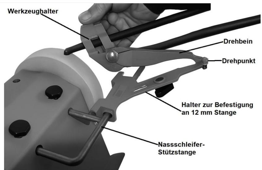
Nehmen Sie die Tru-Grind Halterung (Pivot-base) und verwenden Sie die beiden konkaven Formen neben den Pfeilen (siehe Abbildung oben), um den Abstand zwischen der Stützstange und der Nassschleifscheibe einzustellen. Arretieren Sie die Stützstange durch Anziehen der zwei Knöpfe.
