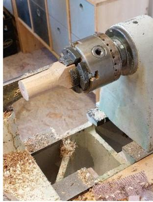
Nun wird die Bohrung für die Quaste angebracht. Möglicherweise müssen Sie die Bohrung noch ein wenig anpassen, für einen Drechsler ist dies aber ein Klacks.
