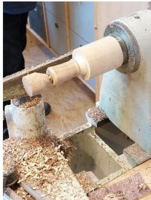
Der Boden des Rasierpinsels sollte für den besseren Stand leicht hohl gedreht werden.
