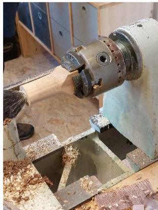
Nun wird ein Hilfsfutter gedreht. Bohrung und Zapfen sollten gut klemmen.
