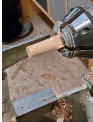
Bringen Sie eine Bohrung für eine M4 Stockschraube oder einen M4 Gewindestift an. Achten sie Beim Eindrehen auf die Flucht.
