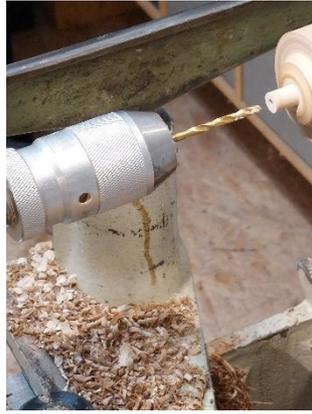
Nun wird mit dem Reitstock moderat Druck ausgeübt und der Griff in die gewünschte Form gebracht.
