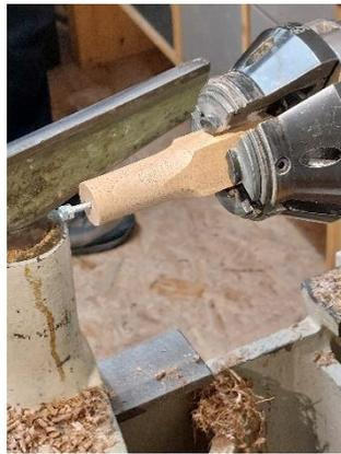
Im Hilfsfutter wird eine 4mm Bohrung angebracht.
