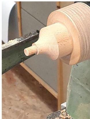
Nun wird der Griff geformt. Nutzen Sie hierbei den Reitstock zur Unterstützung.
