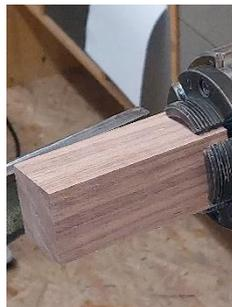
Drehen Sie den vorderen Teil des Kantels rund. Nach dem winkligen Abstechen und dem Ankörnen wird gebohrt. Verwenden Sie einen Bohrer der geringfügig kleiner ist als die Breite der Angel.
