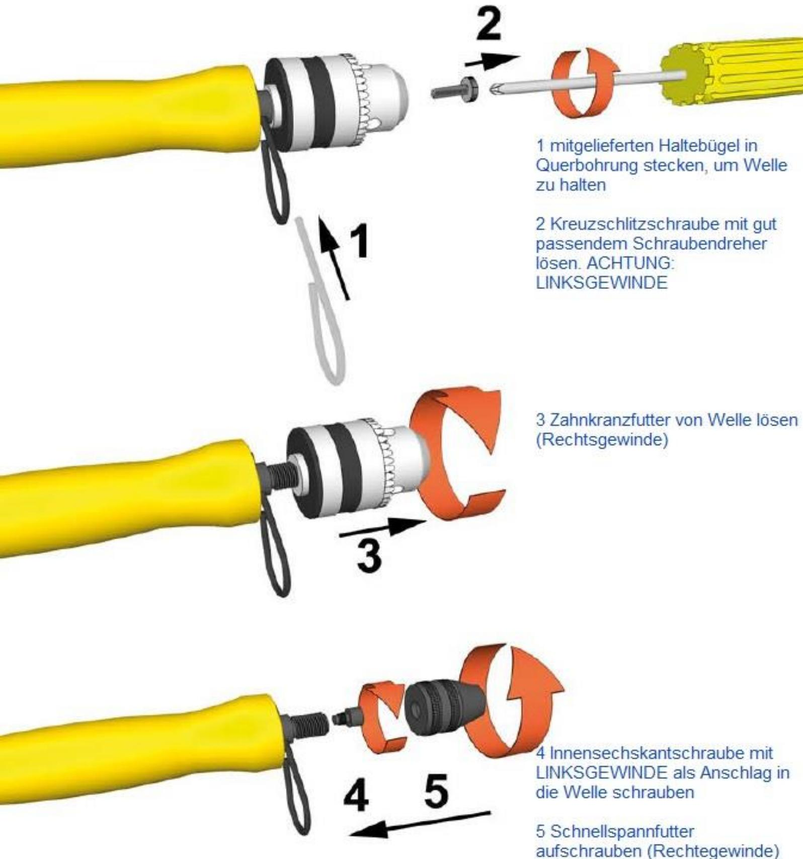
1 mitgelieferten Haltebügel in Querbohrung stecken, um Welle zu halten
