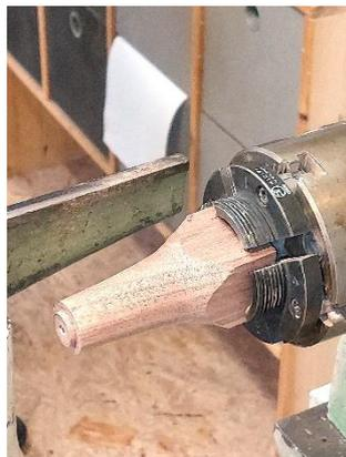
Verwenden Sie zur weiteren Bearbeitung ein passendes Schraubenfutter.
