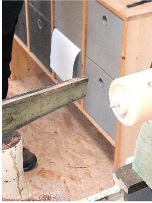
Das Werkstück wird aufgeschraubt und mit dem Reitstock abgestützt.
