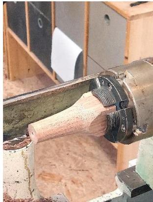
Jetzt wird ein kleiner Zapfen für die Heftzwing angedreht.
