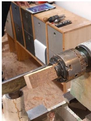
Nach dem Planstechen wird die Bohrung für die Angel angebracht.
