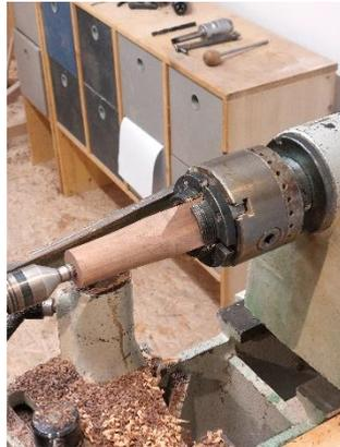
Vermessen Sie nun die Angel. Es wird zweistufig gebohrt: zuerst die größere Bohrung!
