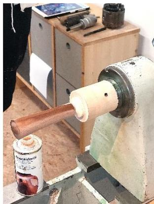
Alle Teile werden zusammengesetzt. Verwenden sie einen 2K Epoxidkleber.
