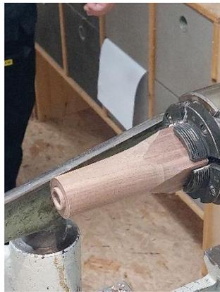
Fertigen Sie sich ein Hilfsfutter. Der Zapfen sollte schon stramm in der Bohrung sitzen.
