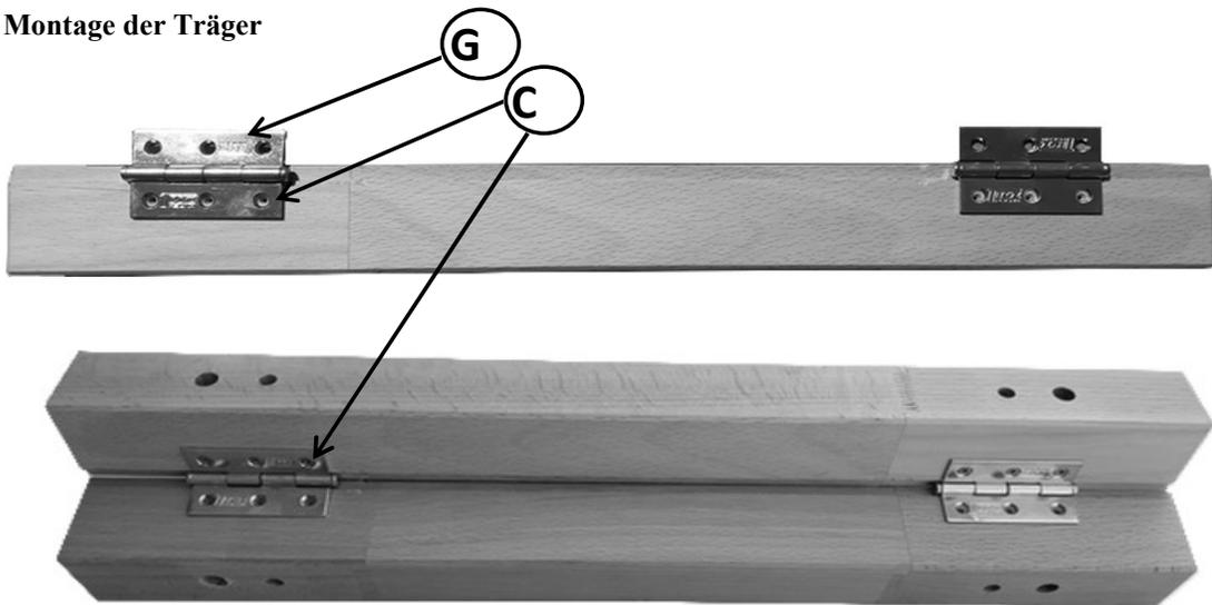
Verbinden Sie die Träger (7) mithilfe der Scharniere (G) und der Schrauben (C). **ACHTUNG!!!** Die Packung enthält 2 Träger-Arten. 2 Stück sind mit einer Öffnung für den Stift (Arretierung der Platte) versehen und 2 Stück sind ohne Öffnungen. Jeder Bock muss jeweils einen Träger mit einer Öffnung für den Stift haben. Die Aussparung an den Trägern muss nach unten zeigen. Die Öffnungen für die Stifte an den Böcken müssen einander zugewandt sein.
