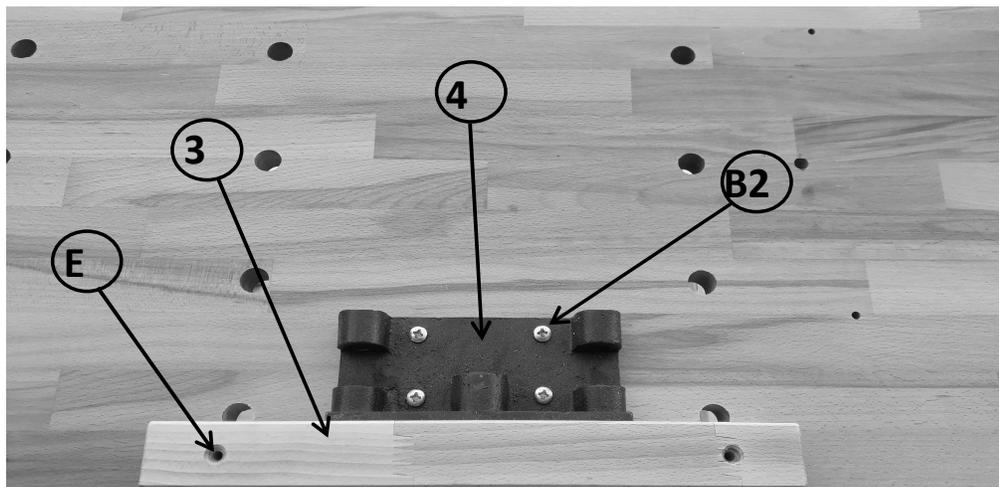
Schleifen Sie die Kanten der Vorderseite der Lasche (3) mit Schleifpapier ab. Schrauben Sie die Vorderseite der Lasche (3) mithilfe einer Holzschraube 5x80 mm (E) in die vorgebohrten Löcher. Schrauben Sie die Spindel (4) aus dem Spindelkörper heraus und befestigen Sie sie mithilfe der Schrauben 6x30 mm (B2) hinter der Vorderseite der Lasche gemäß den vorgebohrten Löchern.
