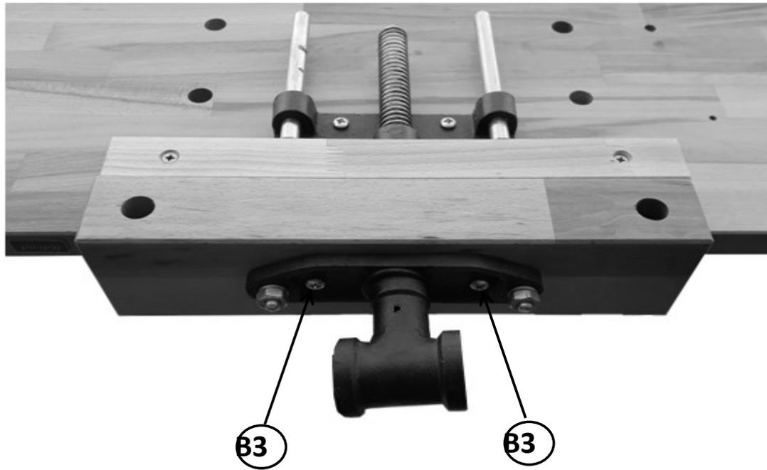
Ziehen Sie die Lasche (2) mithilfe der Spindel fest und vergewissern Sie sich, dass sie horizontal zur Tischplatte liegt. Schrauben Sie dann die Lasche mithilfe der Schrauben 6x40 mm (B3) an die Spindelführung.
