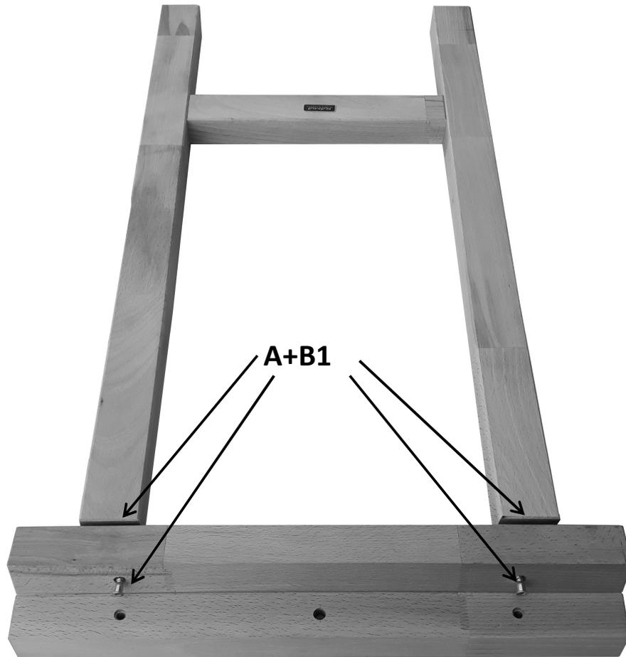
Montieren Sie die verbundenen rechten und linken Beine an die zusammengebauten Träger mithilfe der Stifte (A) und der Confirmatschrauben (B1). Die rechten Beine mit der Stegleiste mit dem Logo müssen am Träger ohne Öffnung für den Stift und die linken Beine mit der Stegleiste ohne Logo am Träger mit der Öffnung für den Stift befindlich sein.
