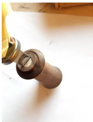
Alle Teile werden nun gleichzeitig zusammengefügt. Verwenden Sie zum Einkleben ein geeignetes Produkt (empfohlen wird 2K Epoxidkleber)
