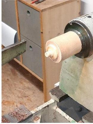
Im nächsten Arbeitsgang wird der Griff mit Reitstockunterstützung geformt.
