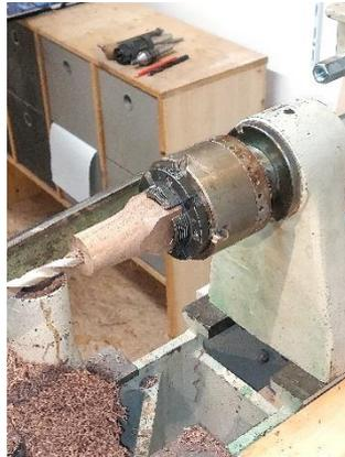
Nun wird ein kleiner Zapfen für die Heftzwing ange dreht.
