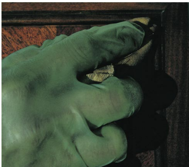
▼ Abb. 5-1: Nehmen Sie das spitze Ende des Ballens, um in Ecken zu gelangen. Drücken Sie mit dem Zeigefinger auf die Spitze des Ballens. Halten Sie den Ballen ständig in Bewegung.
