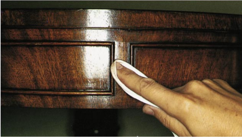
◀ Abb. 5-6: Mit dunkelbraunem oder schwarzem Wachs lassen sich Fehlstellen neben Vertiefungen verbergen. Dadurch hebt sich das Detail gleichzeitig besser ab.
