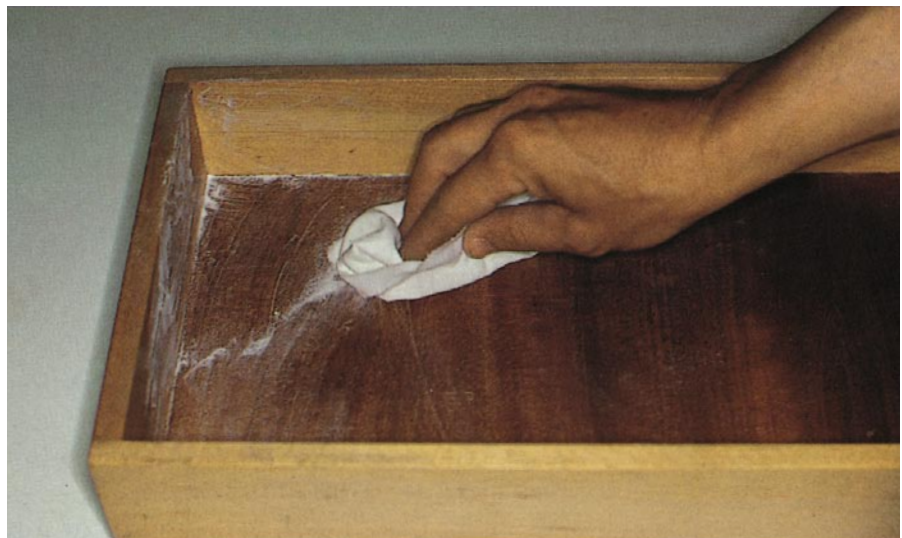
▶ Abb. 5-7: Sie können dem Innern einer Schublade eine traditionelle Behandlung mit 3:1-Knopflack geben, den Sie mit einem weichen Stoffbausch oder einem Pinsel auftragen. Wenn der Lack fast trocken, aber noch klebrig ist, bringen Sie über die ganze Fläche Talkumpuder mit einem Puderbeutel auf. Nachdem der Knopflack ganz trocken ist, wischen Sie den Überschuss davon ab. Talkumpuder gibt dem Knopflack einen Seidenglanz.
