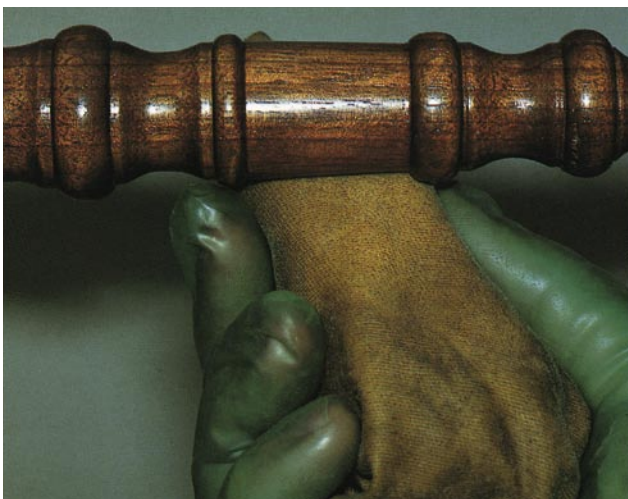
▲ Abb. 5-4: Sie können Drechselteile polieren, während sie noch in der Drehbank sind. Stellen Sie die niedrigste Drehzahl ein. Tragen Sie die Politur bei laufendem Werkstück auf.
